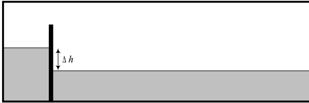
Gambar 5. Model akuarium untuk menghasilkan gelombang pada permukaan air dangkal.
