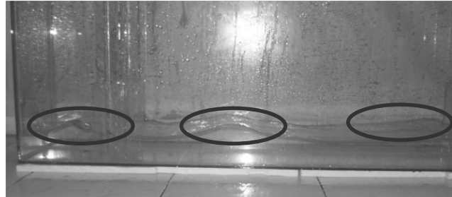
Gambar 7. Gelombang permukaan yang dihasilkan berbentuk sinusoidal pada kondisi percobaan (1).
